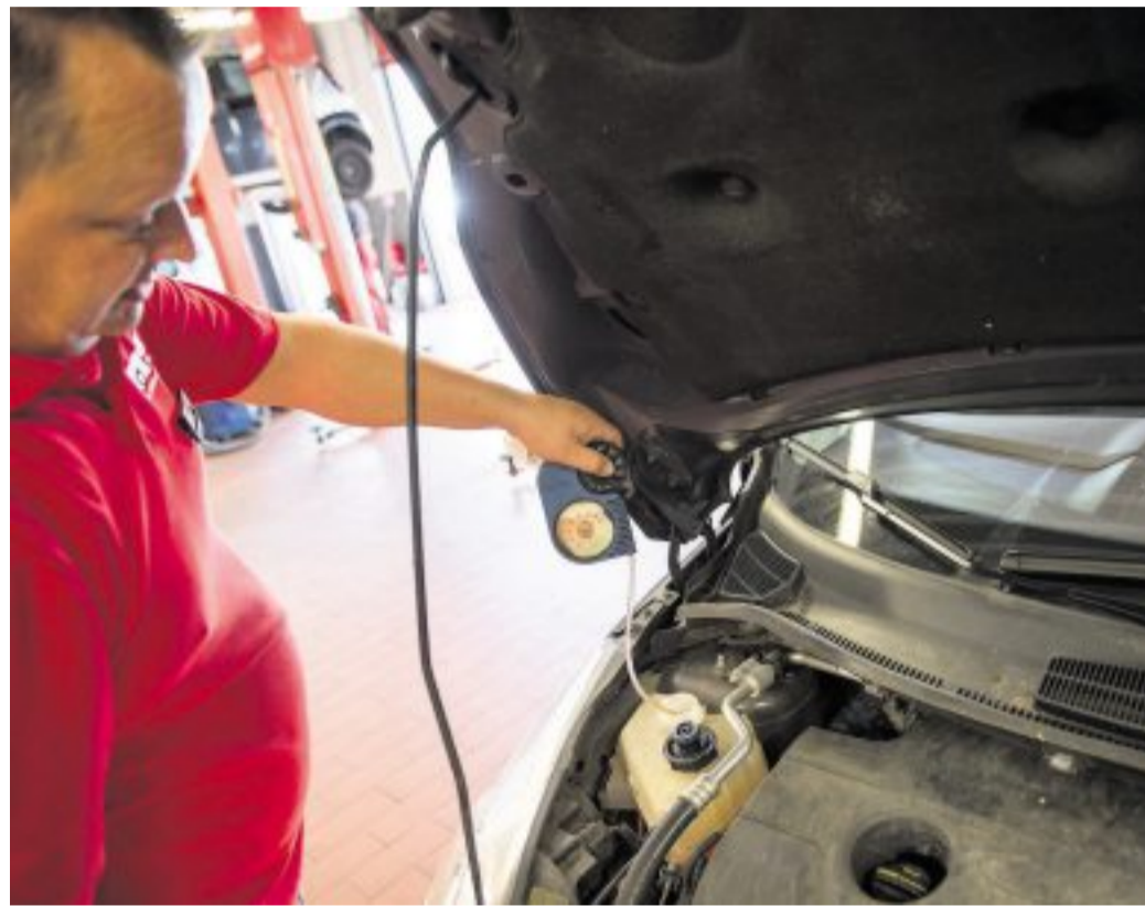
Bevor es draußen richtig kalt wird, sollte der Frostschutz im Kühlwasser überprüft werden. —FOTO: INGA KJER
